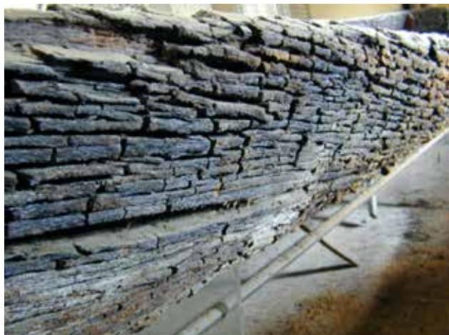
Fig. 35. Museo Archeologico di Ferrara: piroga altomedievale scavata, reinterro e estratta dopo 8 anni. Gli attacchi fungini hanno causato l'attacco da carie cubica sullo strato esterno (circa 2 cm), mentre la porzione interna dello spessore del legno (visibile in alto a sinistra nell'immagine) è ancora in ottimo stato di conservazione.
